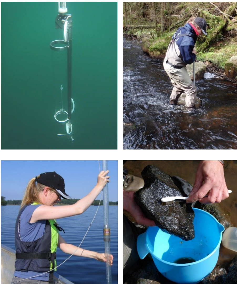
Figur 3. Några provtagningstyper som utförs inom Nissans recipientkontrollprogram. Ö.v: Vattenkemiprovtagning. Ö.h: Bottenfaunaprovtagning i rinnande vatten. N.v: Provtagning av växtplankton. N.h: Provtagning av kiselalger.
