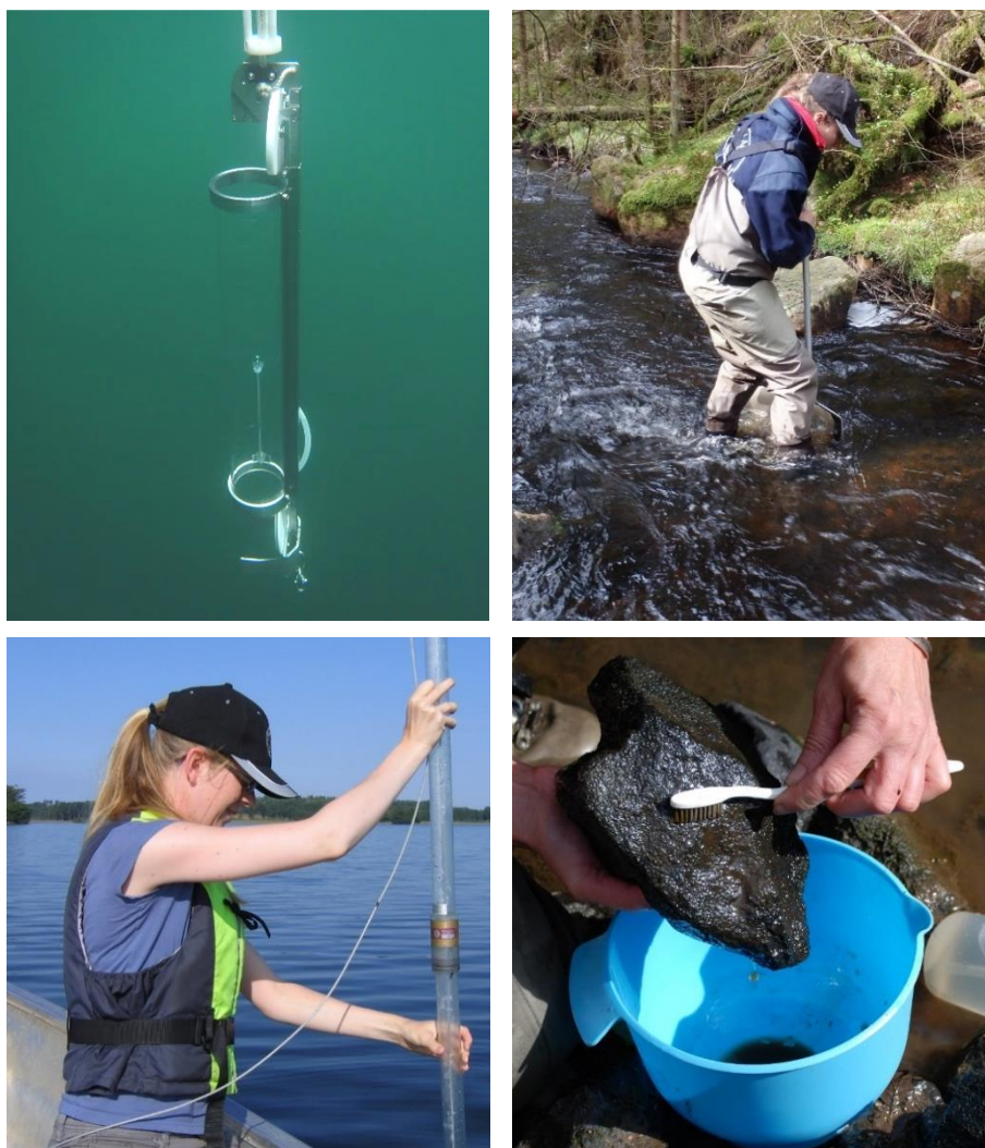
Figur 3. Några provtagningstyper som utförs inom Nissans recipientkontrollprogram. Ö.v: Vattenkemiprovtagnig. Ö.h: Bottenfaunaprovtagnig i rinnande vatten. N.v: Provtagnig av växtplankton. N.h: Provtagnig av kiselalger.
