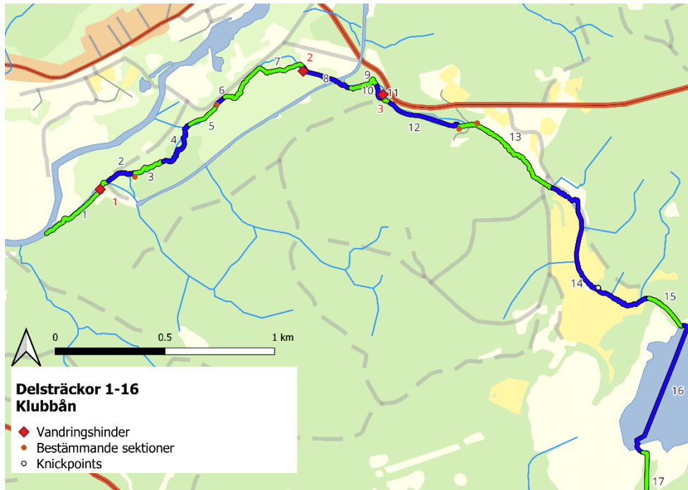
Figur 23. Sträckindelning delsträcka 1–16 i Klubbån. Vandringshindrens numrering syns med röda siffror och delsträckorna i svarta siffror. Delsträckorna visas i kartan i grönt och blått för att visualisera sträckindelningen som gjorts. Notera den nu igenlagda kanalen som korsar vattendraget på delsträcka 8.
